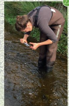
À gauche : dimensions d'une particule de substrat. On retient uniquement la dimension **b** de la perpendiculaire au plus grand axe. À droite : application de la méthode de Wolman sur la Druance (14).
