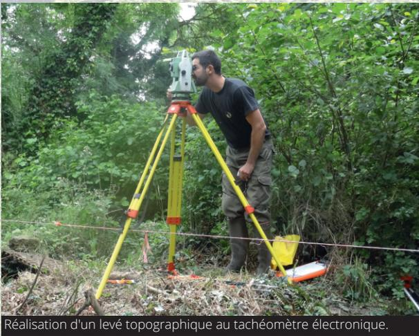
Réalisation d'un levé topographique au tachéomètre électronique.
