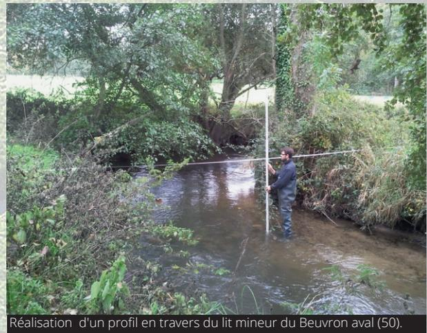
Réalisation d'un profil en travers du lit mineur du Beuvron aval (50).
